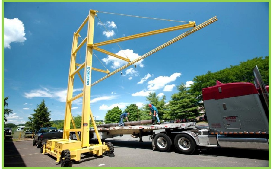
Şekil 5.5. Araç üzerinde düşmeye karşı koruma [32]
