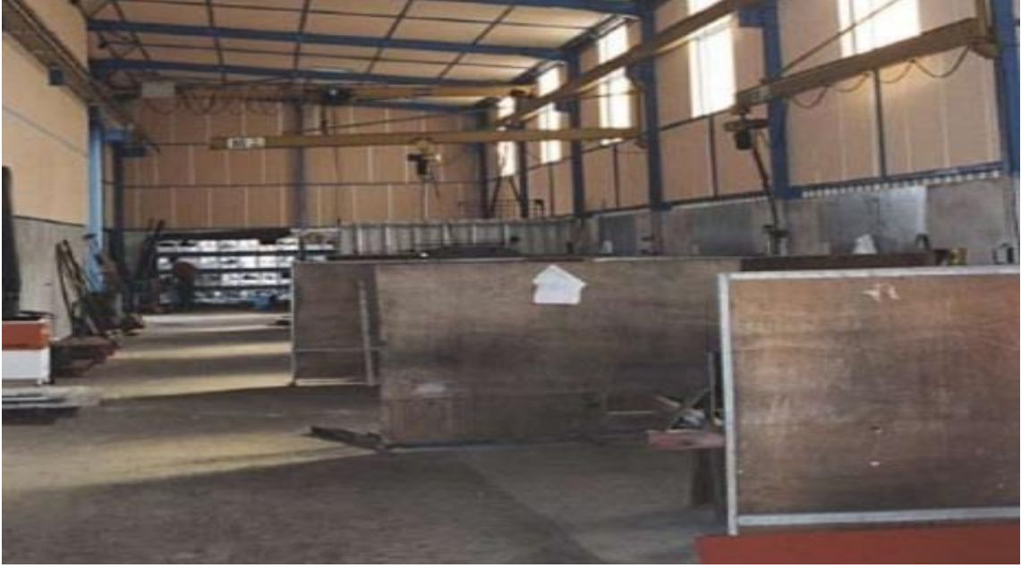
Şekil 2.20 Metal işleri– Paravan Uygulaması
