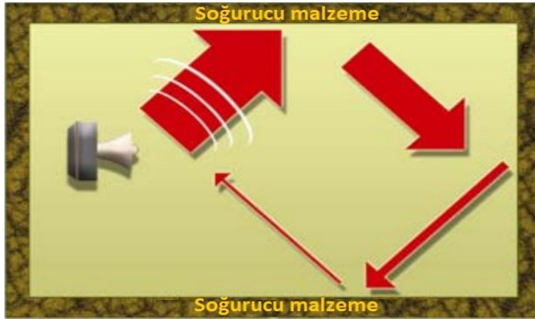
Şekil 2.2 Soğurucu malzemenin etkisi
